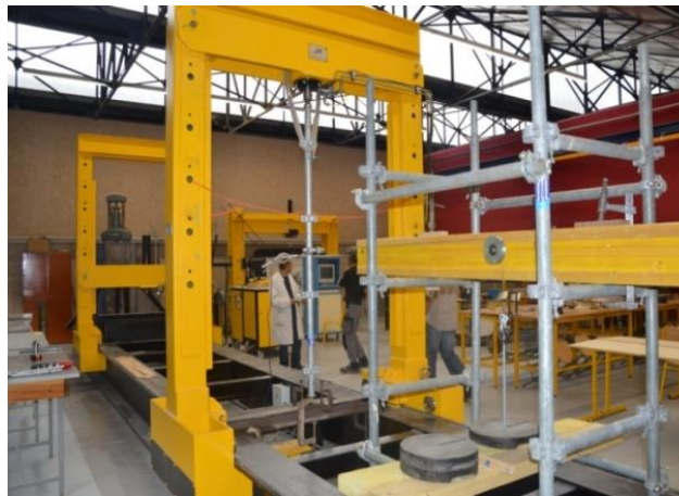
Figure 1. Dispositif d'essai pour les barres isolées
