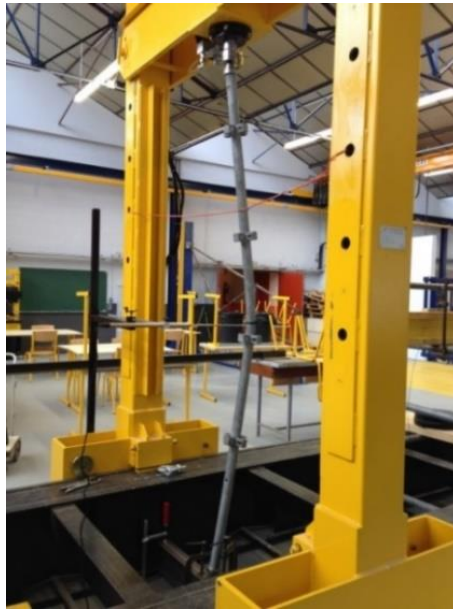
Figure 3. Déformée finale d'un poteau soumis à la charge de ruine
