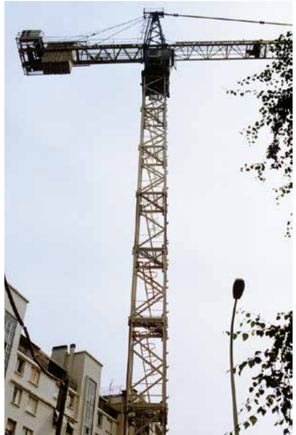
Échelles inclinées avec paliers intermédiaires
