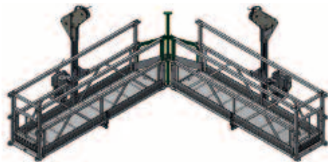
Figure 20. Plate-forme à angle réglable avec étriers « à col de cygne » (© SFECE).
