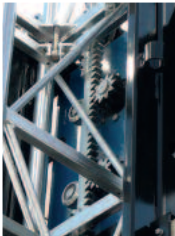
Figure 34. Système d'élévation avec pignon et crémaillère (© SFECE).
