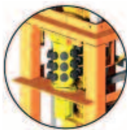
Figure 35. Mécanisme d'élévation avec vis sans fin (© SFECE).
