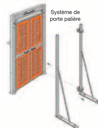
Figure 58. Dispositifs installés aux étages avec porte palière de pleine hauteur (de 2 m et grillagée) (© SFECE).
