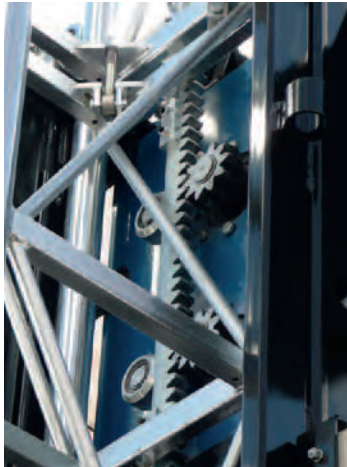
Figure 34. Système d'élévation avec pignon et crémaillère (© SFECE).
