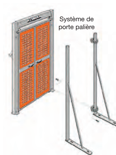
Figure 58. Dispositifs installés aux étages avec porte palière de pleine hauteur (de 2 m et grillagée) (© SFECE).
