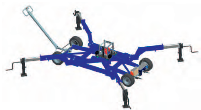
Figure 37. Châssis mobile avec timon et stabilisateurs (© SFECE).
