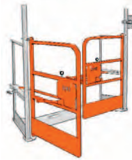
Figure 51. Exemple de dispositif aux étages pivotants (© SFECE).
